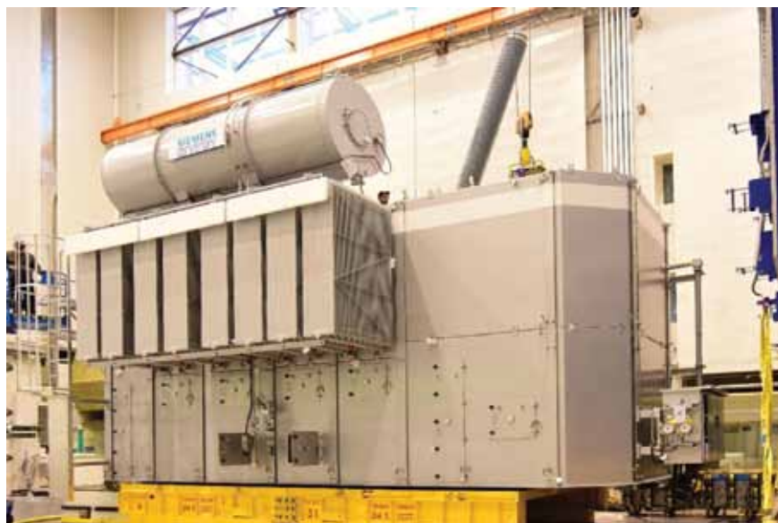
Obr. 2: Variabilní kompenzační tlumivka při technických ověřovacích zkouškách ve výrobním závodě Siemens Energy, Weiz, Rakousko
