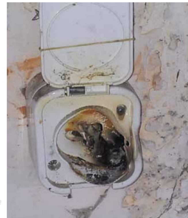
Obr. 3 - spálená zásuvka vlivem sériové poruchy
