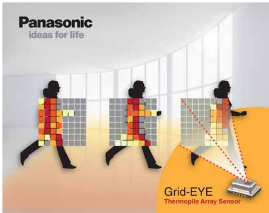
Grid-EYE – dokáže detekovat přítomnost i směr pohybu v matici 8x8
