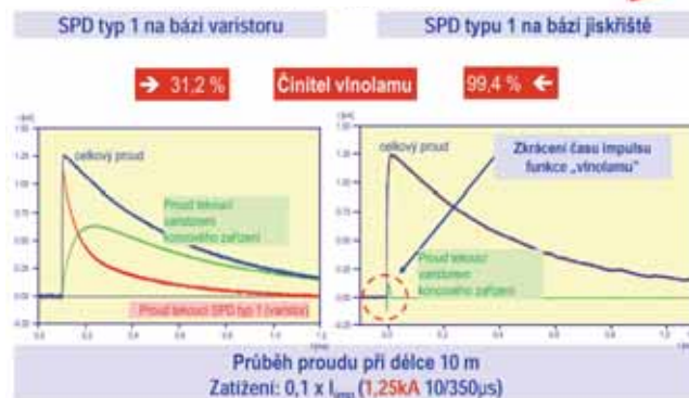
Obr. 7. Činitel vlnolamu - energetická koordinace mezi svodiči SPD
